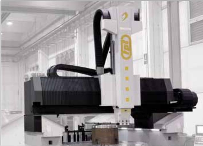
CNCマシンツールで使用されている多様な吊り下げ、エネルギーチェーン 縦スタンド、回転、フリースパン。
