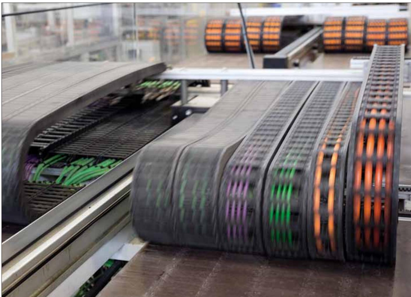
チェーンフレックス可動ケーブルを組み込んだエネルギーチェーンを高加速テスト
