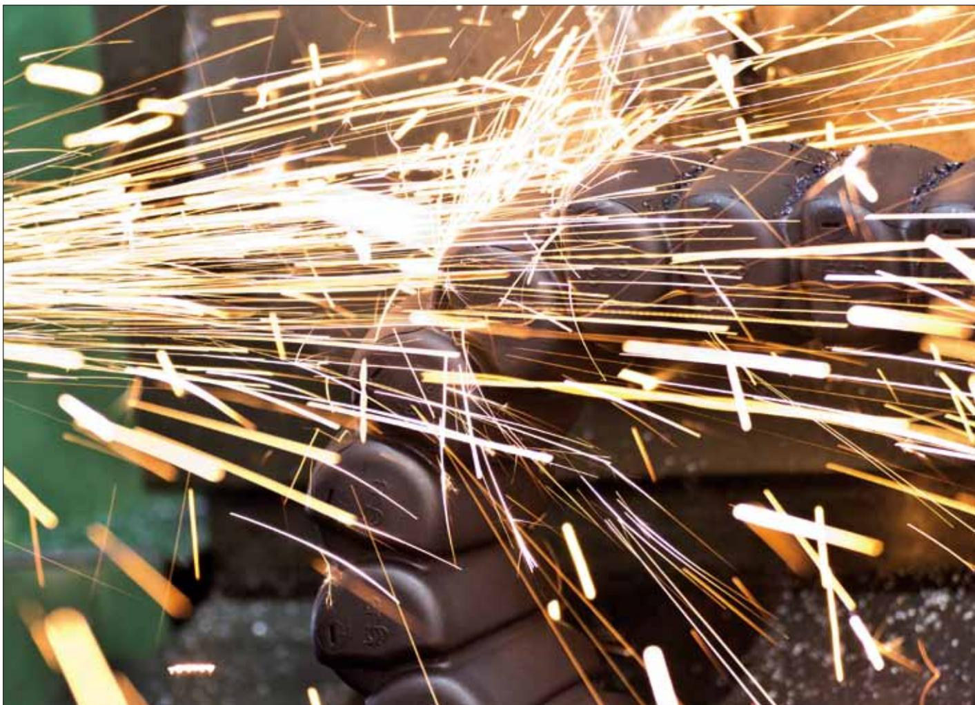
最高 850°Cのチップに耐える：HT 材質（オプション）使用のエネルギーチューブ RX
