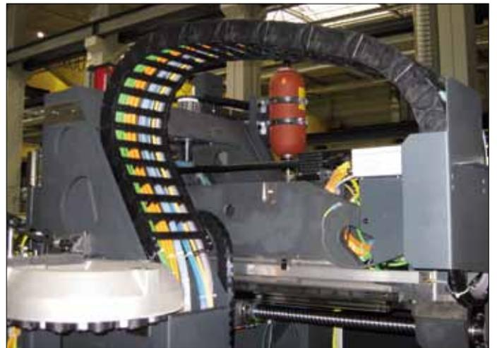
柱がスライドする機械：小さなスペースを守りコストを低く抑えるため、エネルギーチェーンE4.42は垂直に設置されている。
