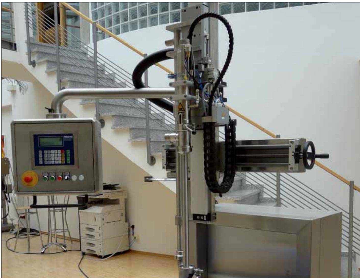
充填システムはモジュラー式で幅広い要件に対応できるようになっています。ドライリン・リニアガイドが位置調整をし、エネルギーチェーンが電気と通信を可動部分へ供給しています。
