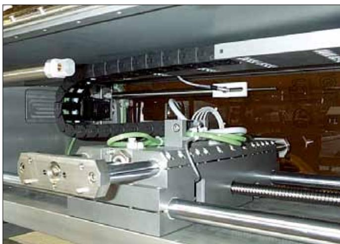
熱成形機に使用されるドライリン、エナジーチェーン、チェーンフレックスケーブル
