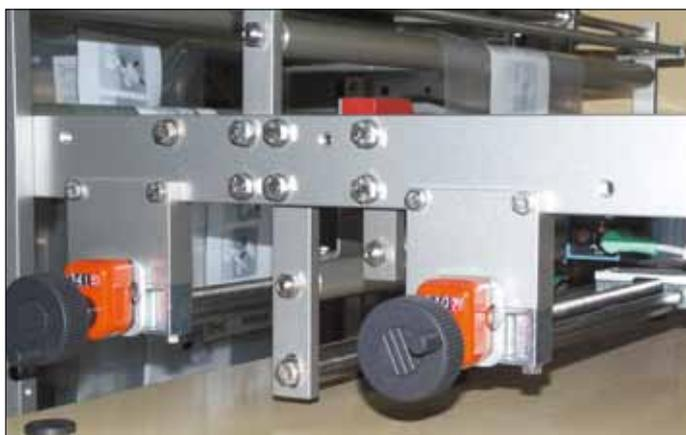
位置表示器とハンドホイール付きのドライリン SLW スライドテーブルが織り端と印刷位置検知用センサーの位置決めに使われています。
