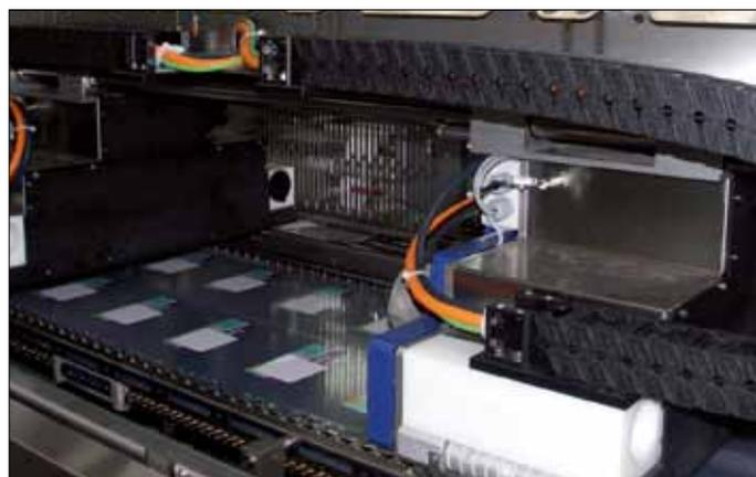
インラインラベラーに取付けられた低振動の電力および通信ケーブルをガイドするエナジーチェーン E6 シリーズ
