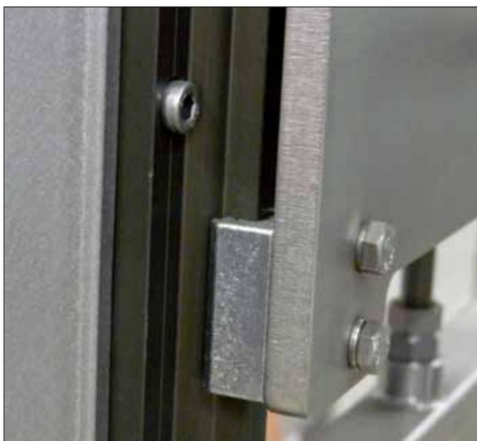
ボトルの首部分のラベルを外す装置に使われるドライリン W リニアガイド。メンテナンスフリーで洗浄液への耐性を備えています。
