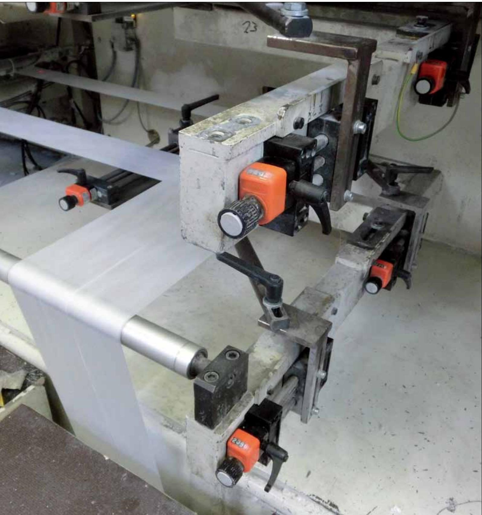
ドライリン・スライドテーブル SHT-12-AWM 型が 4 本の織ベルトのたわみ調整に使用された事例。全部で 8 基が稼動中です
