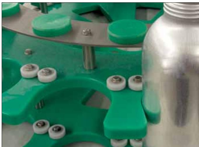
様々な包装機械で使われるクシロス・ポリマー製ボールベアリング。とても丈夫で動きがスムーズな上に、金属製ローラーベアリングよりも経済的です。
