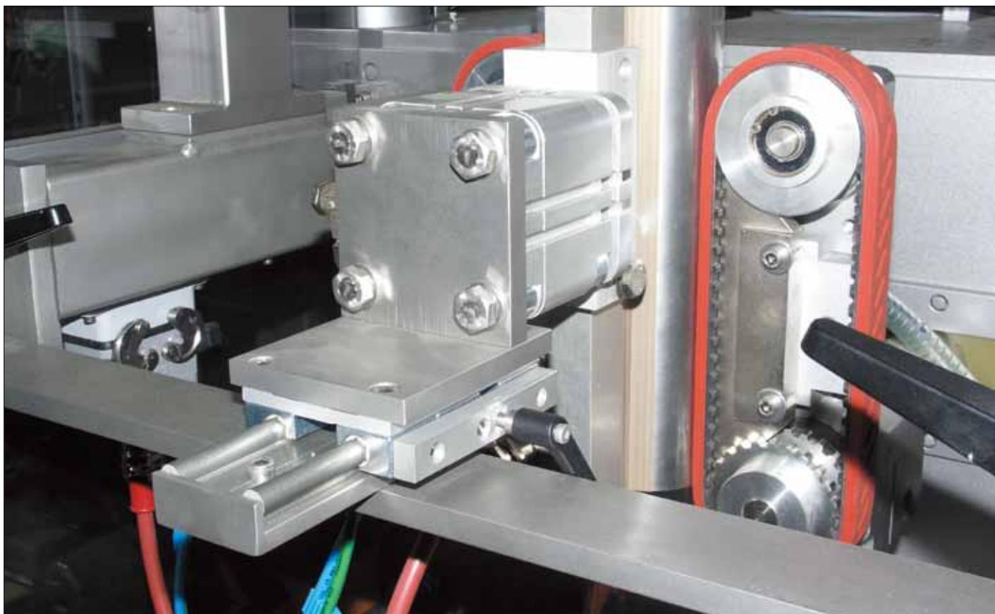
長い密封口の位置調整をするのにドライリン W リニアガイドが使われています。手動クランプ付きで早くて簡易な位置決めが手で調整できます。
