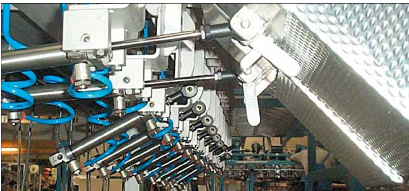
充填／キャップ締め機：空圧で動くフラッパーに使われたイグボール球面ベアリング。耐薬品性をそなえた無潤滑運転と、減振性効果で騒音を極力抑えることができました。
