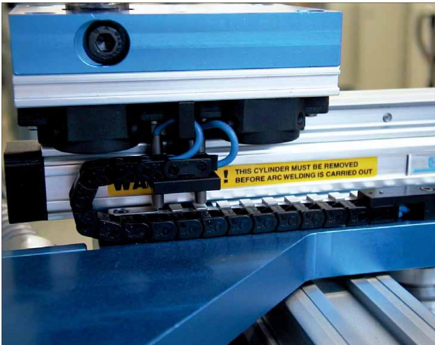
とても限られたスペースにもフィットする曲げ半径 4xd のチェーンフレックスケーブルとエナジーチェーン。
