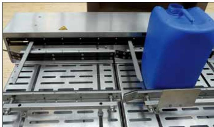
見えないところに取り付けられているものの、充填するための容器を運ぶのにドライリン W ガイドレールがスムーズな動きを実現しています。
