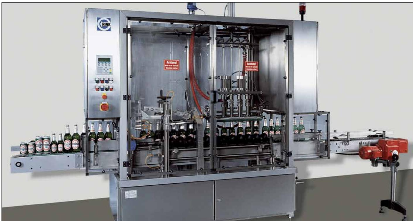
自動でボトルを空にする装置。このバルブ部分にドライリン R スライドベアリングが使われています。
