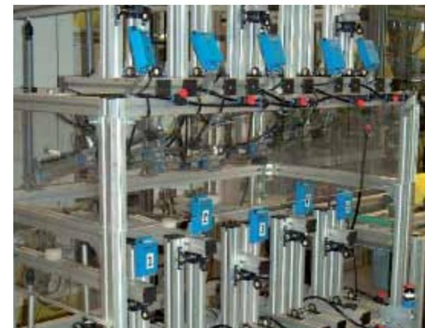
振動耐性試験装置で中程度の負荷を想定し振動耐性をテスト
