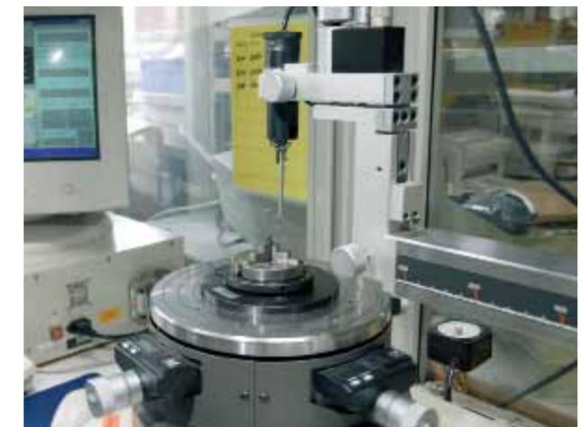
圧入式すべり軸受の内径を測定
