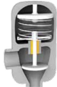
イグリデュールすべり軸受は短かいストロークの直動が可能で、極端な汚れや汚染物質、排気ガスや高温に耐えられます。
