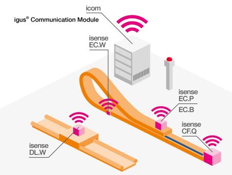
スマート・プラスチックは稼働停止を回避します。 インテリジェント製品は事前にメンテナンス時期 を知らせ、メンテナンスの過程も統一化します。
