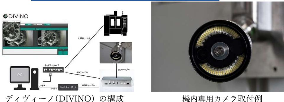
一般的なカメラは内部を可視化するだけで、クーラントや切り粉の影響を受けやすく主軸近くに設置することが容易ではありません。ディヴィーノ(DIVINO)は工作機械専用が開発されたロトクリアカメラを主軸横に取付け、工作機械と連動させることで、加工プログラムのスタートと同時に自動で録画を始め、加工終了で録画を停止させます。加工中にアラームや事故が発生した場合は速やかに録画を停止させ、動画を確認し分析することで原因究明に役立ちます。同時にマスターワークを認識させ加工前にワークの有無、種類、配置ズレを判定しポカミスを軽減します。
