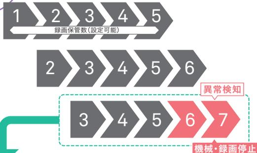
異常を検知すると機械が停止し、同時に録画も停止します。機械停止前の数秒間(保管数)を動画で再生できますので、異常やエラーの原因究明がその場で即座に行えます。
