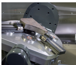
7 5軸加工機での異型ワーク固定例
