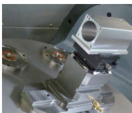
12 5軸かさ上げセンタリングバイス使用例
