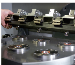
1 4個のワークを一度に取り付け段取り削減
