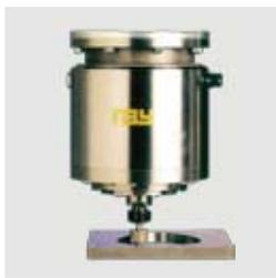
汎用機に遊星機構を付加、0.001mm代の切り込みを可能にした、10万回転の高周波スピンドル。超高周波スピンドルと精密遊星ヘッドで、高精度・高能率の穴加工を行います。真円度は2μ。
