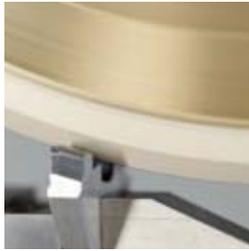
特殊結合で、砥粒の脱落を防止しています。長寿命でレイ研削ヘッドにベストマッチ。
