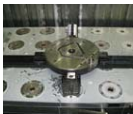
2 形状の異なるワーク を同時にクランプ して段取り削減
