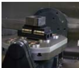
9 生材のクランプ “しろ”を極限まで 抑えた強力爪
