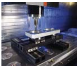
10 バイスにバイスを 直行させた使用方法
