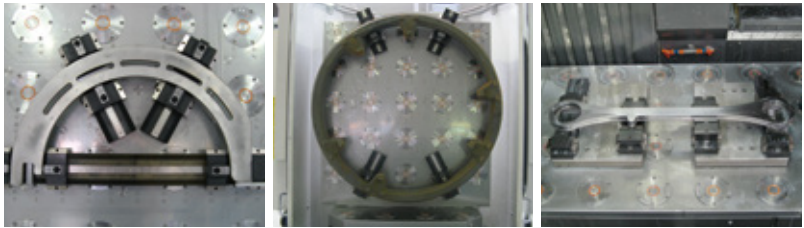
4 半円ワークも固定可能 5 円形ワークをイケールに固定 6 異型ワークも簡単に固定可能
