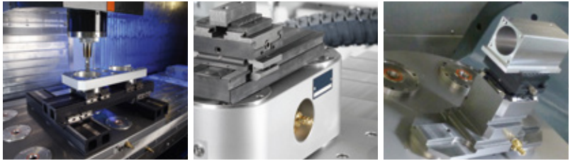
10 バイスにバイスを直行させた使用方法 11 バイスレールにセンタリングバイスを固定 12 5軸かさ上げセンタリングバイス使用例
