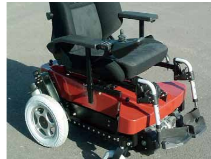
耐食性及び耐摩耗性に優れた軸受をホイールに使用した電動車椅子で階段を昇降
