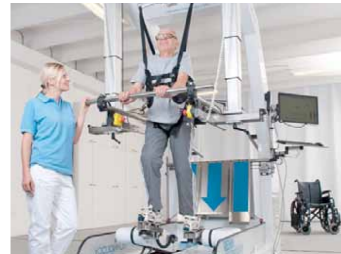
エネルギーチェーンの搭載で、セラピーロボットが故障知らずで連続動作可能に
