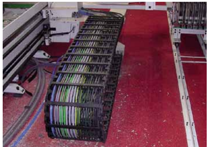
エネルギーチェーン E4 を木材加工機械縦方向ストロークで使用
