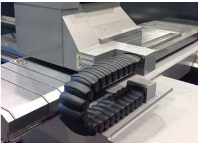
マシニングセンターにケーブル保護管 RX を採用
