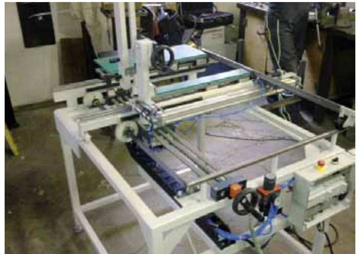
ドライリン SHT スライドテーブルをベニア合板機械に採用
