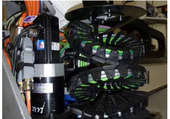
縁材接着機械で使用されるツイスターバンドは7,000度の回転が可能
