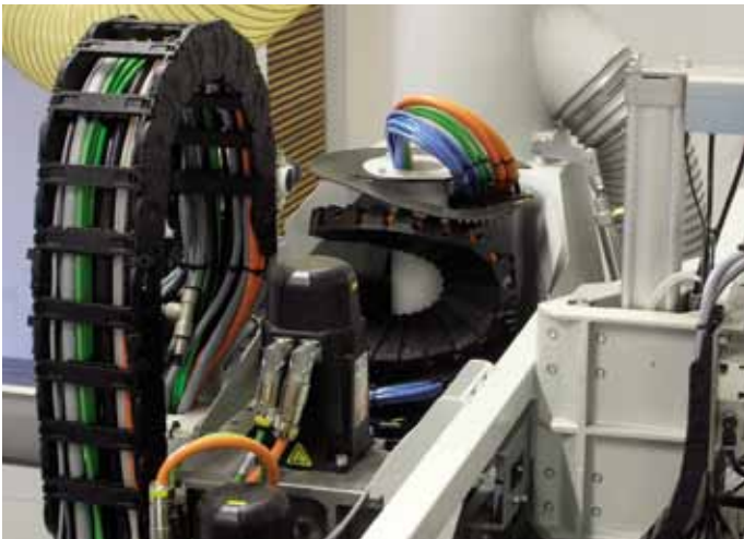
5軸フライスヘッドの電力供給に使用されるエネルギーチェーン。複雑に揺動することが可能な部品を採用したので、機械が経済的になりました。
