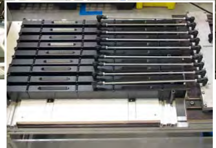
7 種類の素材の外被を使用してのテスト
