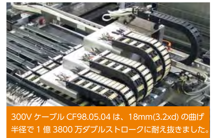
7 種類の素材の外被を使用してのテスト
